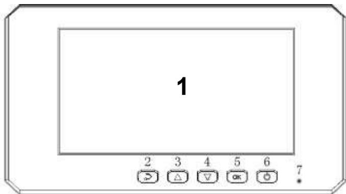
1. 7-дюймовый ЖК-дисплей: отображает такую информацию, как количество пассажиров, аварийные сигналы, уровень сигнала обнаружения, время работы и рабочий канал.
